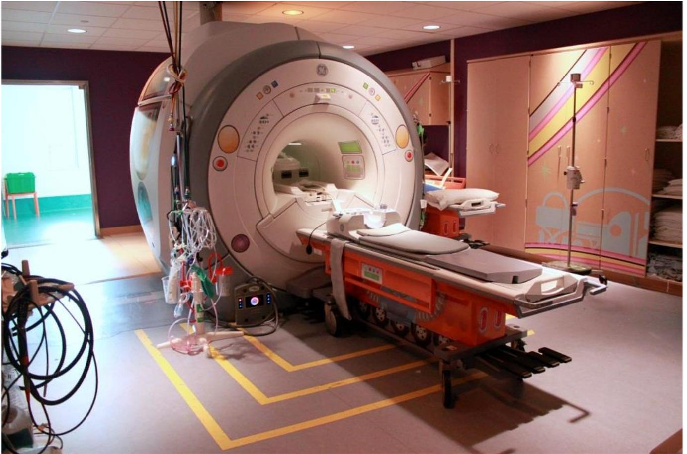
La cámara de resonancia magnética usa un imán muy fuerte para tomar imágenes del interior de tu cuerpo. La cámara está dentro del círculo (o túnel).
